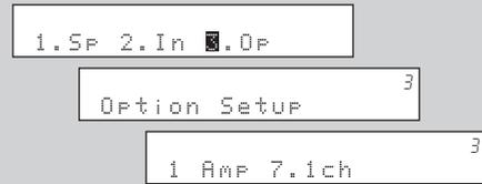
Para adaptarse a sus preferencias, se puede asignar un amplificador de potencia del canal envolvente trasero al canal delantero ("Front A" o "Front B") para la reproducción bi-amp.
